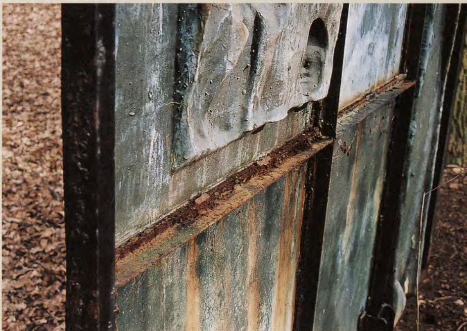
Roestvorming op brons door ijzeren structuur
