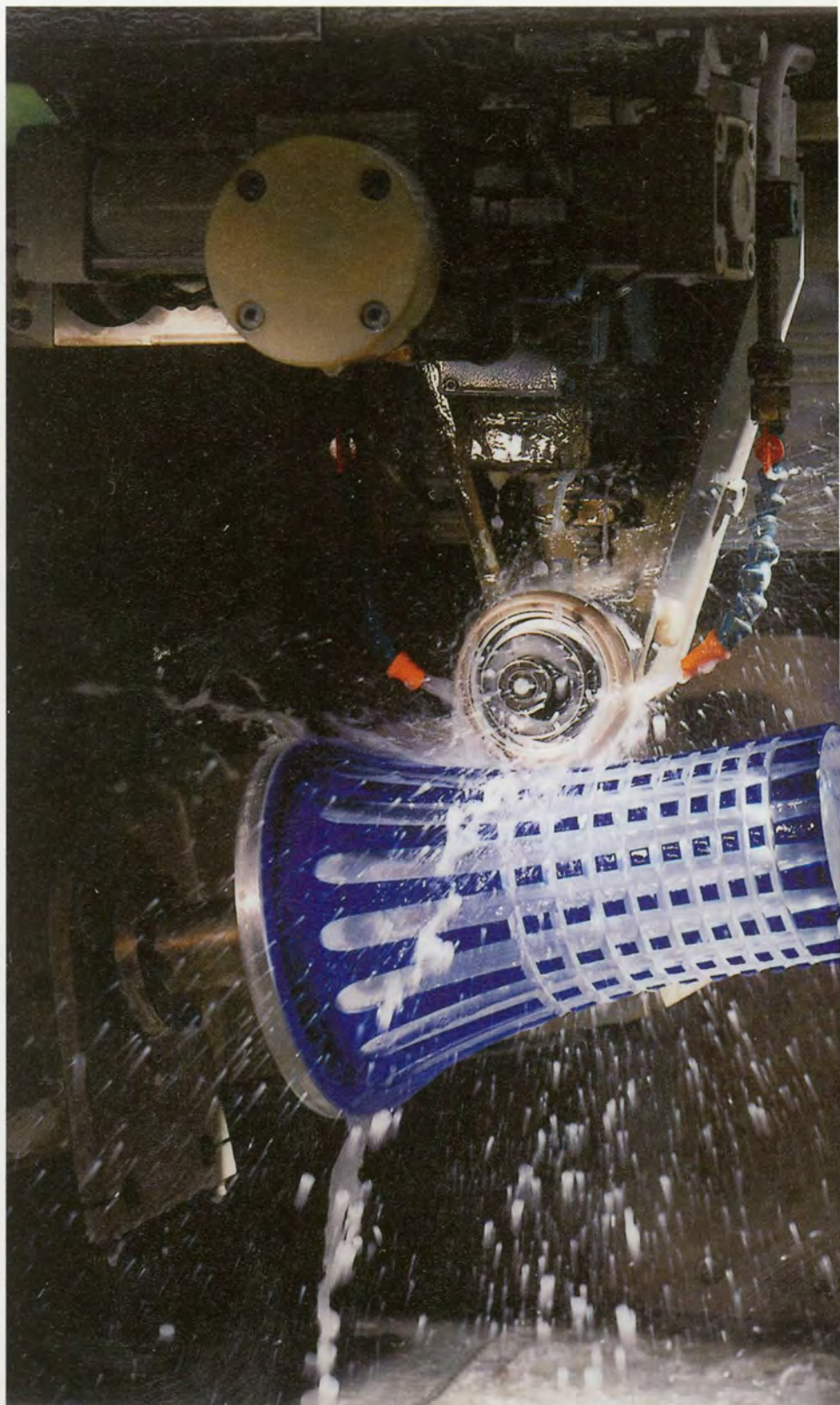
Het slijpen van glas met diamantslijpschijven
