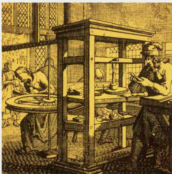
Prent van Jan Luyken: slijpmolen met aandrijf wiel voortbewogen door een vrouw
