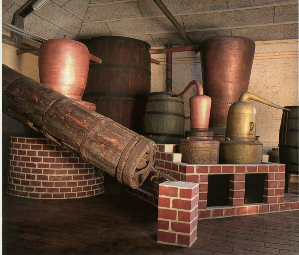
Een schroef van Archimedes op de voorgrond voor het droogmalen van polders en alambieken voor het stoken van graanjenever en likeuren uit de 18de eeuw.
