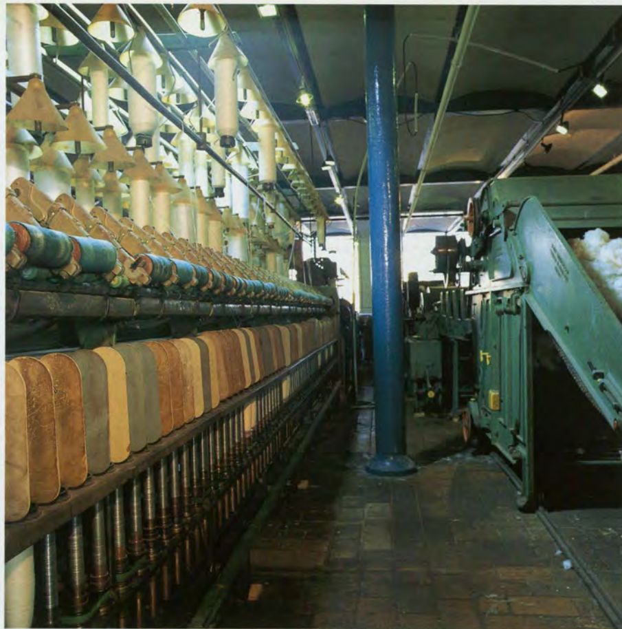
Gezicht in de 'Katoenfabriek'. Links een spinmachine, rechts een klopmachine
